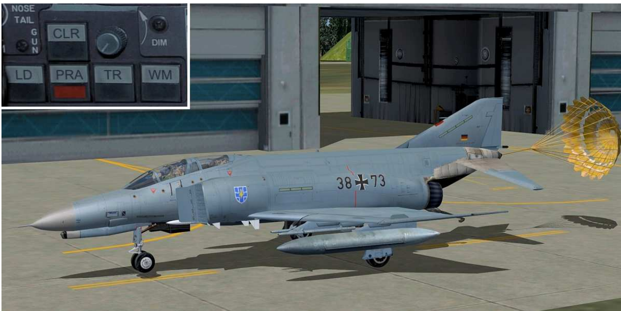
PRA – Ausfahren des Bremsfallschirm ( Parabrake ) bei Bodenberührung
